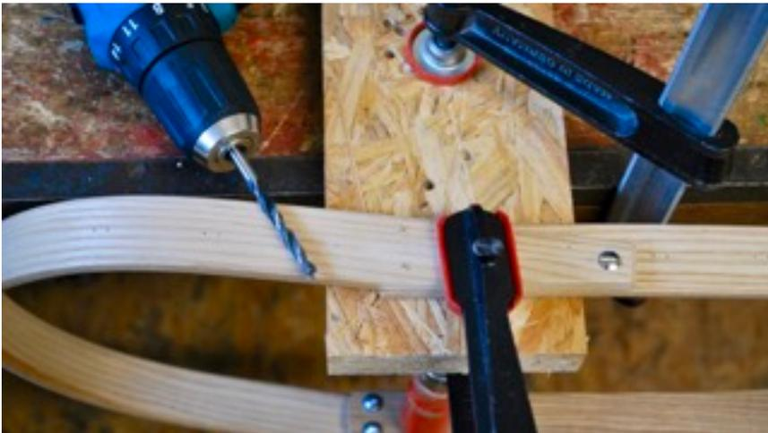
Dann die beiden Bögen passend zu einander ausrichten. Die anderen Löcher im Bereich der Überplattung werden in einem Arbeitsgang durch beide Bögen gebohrt. Passend spannen, dann bohren.
