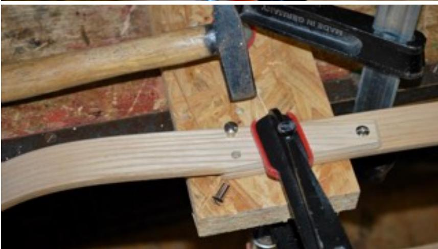
Am besten im noch gespannten Zustand gleich die Hülsenmuttern eintreiben. Dann ausspannen und die Schrauben von innen einschrauben.
