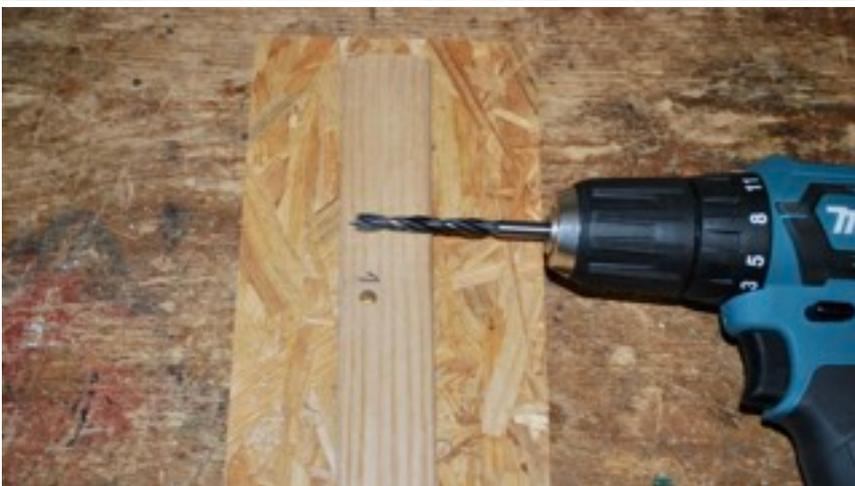
Danach das Loch 1 am Bogen für den hinteren Teil des Schneeschuhs bohren.
