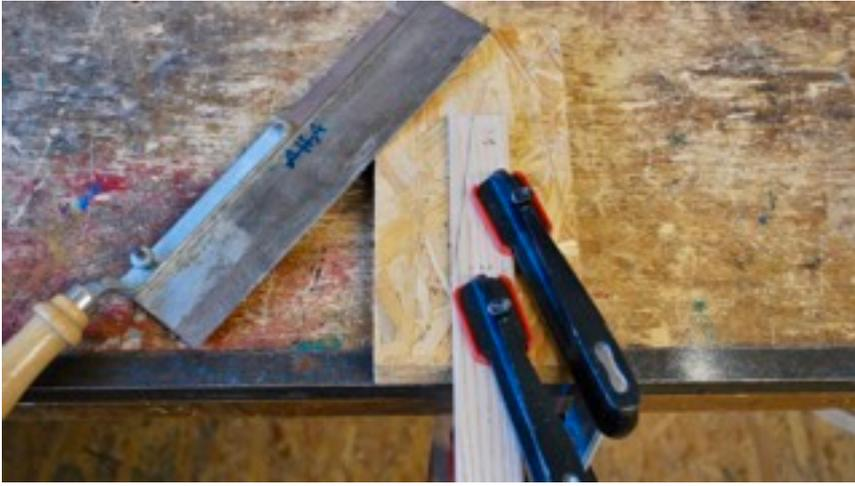
Den vorderen Bogen wieder passend einspannen, um den keilförmigen Überstand abzusägen.
