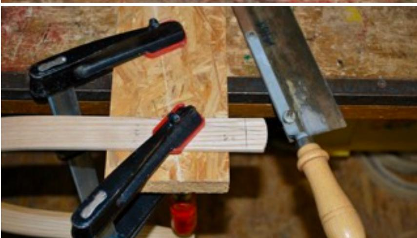
Vorderen Bogen mit Zwingen und passenden Resthölzern einspannen. Überstand mit Feinsäge absägen.
