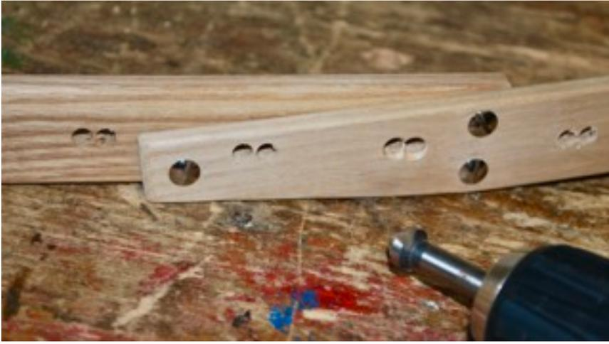
Danach die Löcher von außen mit dem Kegelsenker oder einem größeren Metallbohrer ansenken. Dazu einen geringe Maschinendrehzahl wählen.
