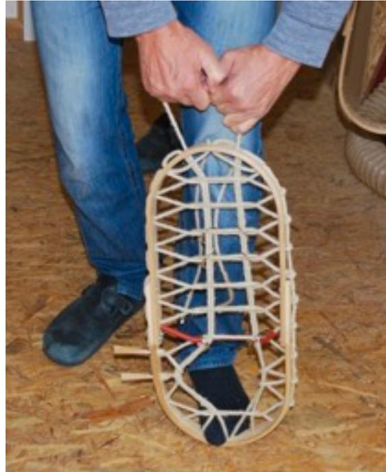
Jetzt spannen: Den Stab wieder rausziehen. Schneeschuh aufrecht positionieren. An dem Seil ziehen, welches als erstes in Längsrichtung verlegt wurde. Kräftig ziehen. Dann den Schneeschuh umdrehen und an dem Seilstrang ziehen, welcher das entstandene Schlappseil straff zieht. So fortfahren, bis alle 4 in Längsrichtung verlaufenden Seilstränge straff sind.
