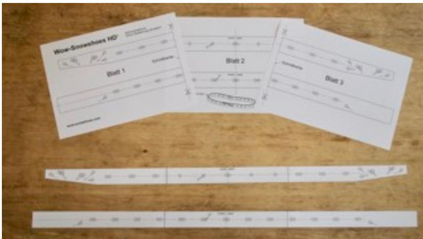
Start: Bohrschablonen herstellen für die beiden U-Leisten (separater Ausdruck). Erst kleben, dann ausschneiden.
