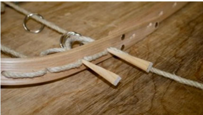
Das fixiert die Schlaufen bis zum Ende, wenn die Spannung in den Schuh kommt.
