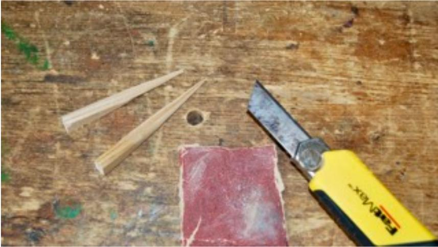
**Zwischenschritt:** Von den keilförmigen Abschnitten (Reststücke vom Sägen) mittels Messer und Schmirgelpapier 2 angespitzte Keilstücke anfertigen.
