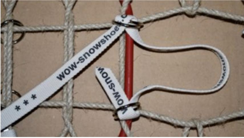
über den ersten drüber und durch den zweiten / inneren Ring durch Richtung Schuhmitte.
