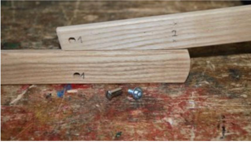
Nun wird der vordere Bogen mit dem hinteren passend durch Loch 1 verschraubt. Die Hülsenmuttern liegen außen, die Schrauben innen.
