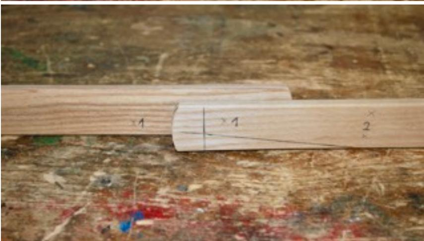
Bohrschablone entfernen. Die Markierungen 1 und 2 auf das Holz übertragen.
