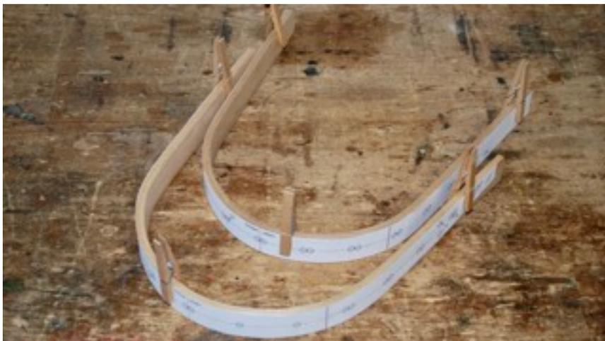
Die Bohrschablonen passend mit Wäscheklammern oder Klebeband um die U-Leisten fixieren.
